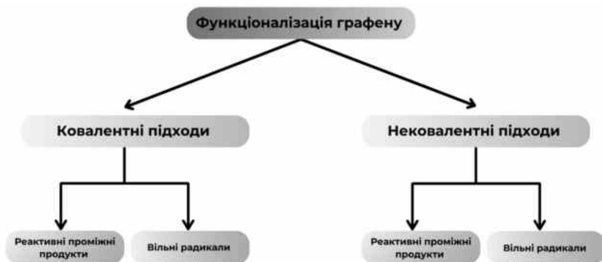
Рис. 1. Схеми ковалентної/нековалентної функціоналізації графену
